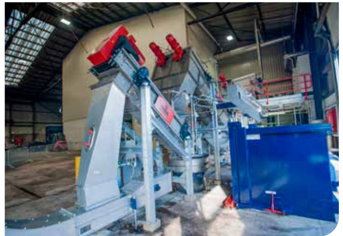
In drie trappen worden de herwonnen plastics gezeefd en gewassen.
