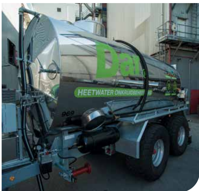
Een tienkuubs heetwatertank van Dar.
