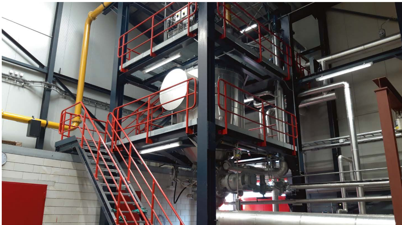
De eerste reactor voor luierreycling bij ARN in Weurt. Volgend jaar komen er twee bij. Foto: ARN
